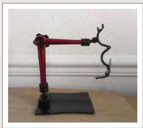
L'ensemble est constitué d'un support articulé avec trois parties amovibles : un socle noir en métal et deux articulations en métal rouge. Un support de serrage permet la fixation du microscope qui est relié à l'ordinateur par l'intermédiaire d'un câble USB 2,
