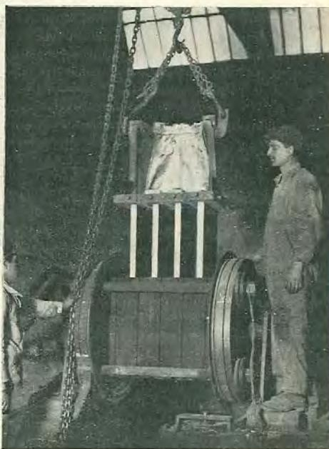
Fig. 5. — Démoulage des 4 plaques de bronze d'aluminium par le procédé Durville.
