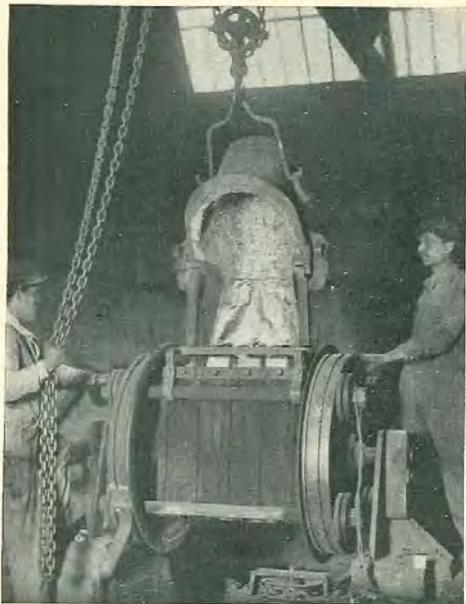
Fig. 4. — Transvasement de l'alliage dans les 4 cases de la lingotière.
