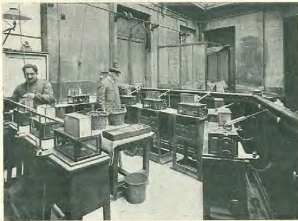
Fig. 8. — Salle des balances automatiques Schmitt, pour la pesée des jetons monétaires.
