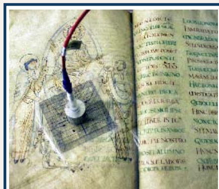
Mesure par spectrophotométrie d'absorption par réflexion diffuse sur un manuscrit de l'abbaye de Fleury. (photo P. Roger Puyot, IRAMAT-CEB/CNRS)
