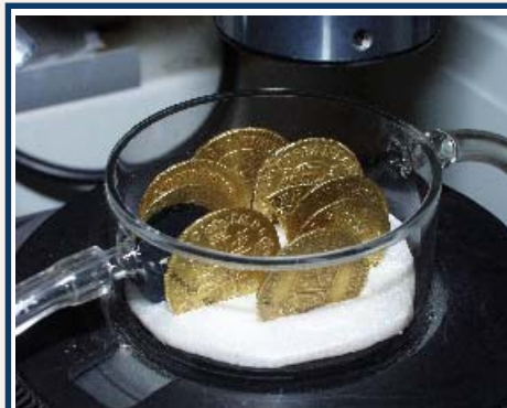
Monnaies d'or dans la cellule d'ablation laser du spectromètre de masse à plasma (LA-ICP-MS). (photo, IRAMAT-CEB/CNRS)
