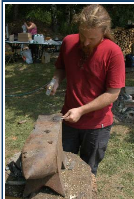
Mise en forme d'une lame pour la fabrication de flan monétaire sur la plateforme expérimentale du site des Mines d'Argent des Rois Francs à Melle (Deux-sèvres). (photo, IRAMAT/CNRS)
