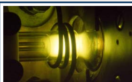
La torche à plasma du spectromètre de masse ( T : 8000^{\circ}\text{C} ). (photo, IRAMAT-CEB/CNRS)
