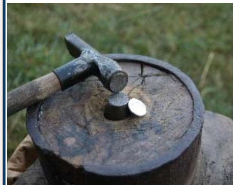
Reconstitution de la frappe au marteau sur la plateforme expérimentale du site des Mines d'Argent des Rois Francs à Melle (Deux-sèvres). (photo, IRAMAT/CNRS)
