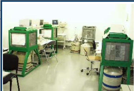
Salle de mesure par spectrométrie gamma pour l'analyse des monnaies en alliage cuivreux. (photo, IRAMAT-CEB/CNRS)
