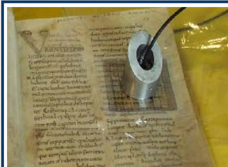
Mesure par spectrophotométrie d'absorption par réflexion diffuse sur un manuscrit de l'abbaye de Fleury. (photo P. Roger Puyot, IRAMAT-CEB/CNRS)
